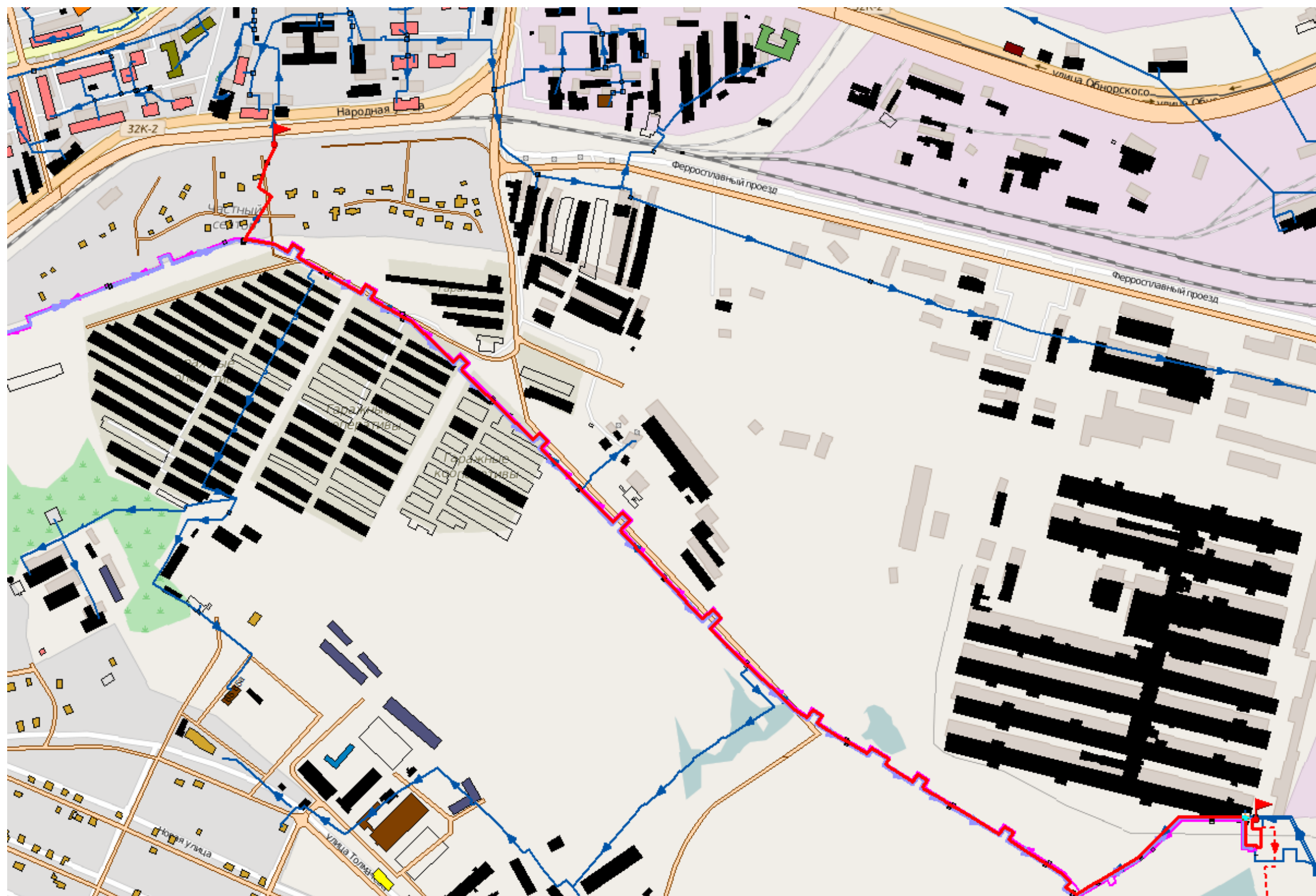
Рисунок12. Путь построения пьезометрического графика КТЭЦ коллекторная-НО23 (Магистраль №4)
